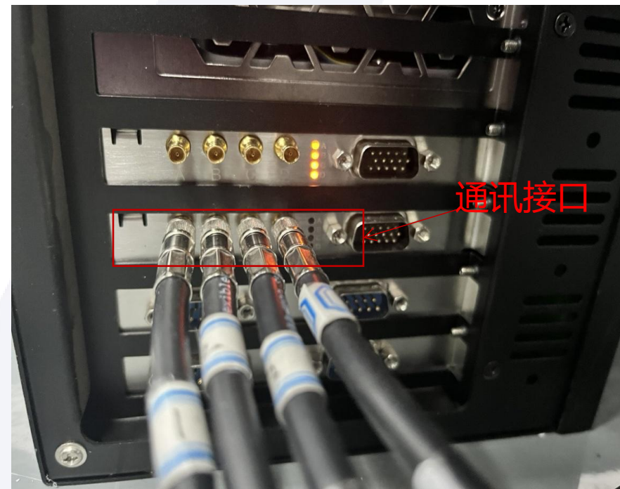
图像采集卡（采集卡已插入电脑）
